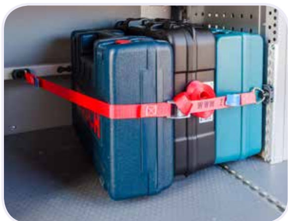
De sjoband in combinatie met aluminium railprofiel tegen de zijdelen
